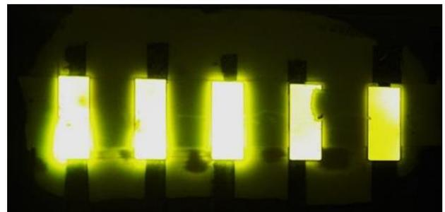
図 2 グラフェン透明電極を利用した高分子 OLED が点灯する様子(PEN 基材)図 1 グラフェン
