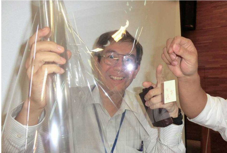
写真7：透明なフィルム上に、グラフェンを1原子層つけたもの（市販されている）。1原子層かどうかは光の透過率が1層あたり2.3%であるので、濃淡から判断できる。写真でフィルムの上部にグラフェンがついているところとついていないところの濃淡の差がかすかに見える。この市販されているシートを何に使えるかは、わかっていない。
