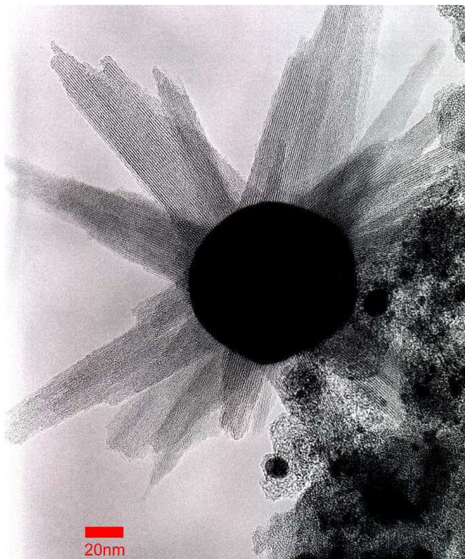
図5：NiPd 触媒から伸びるナノチューブの束〔都立大方浦先生〕
