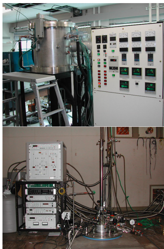
(上) 新機能物質創製用3ゾーンタングステンヒーター炉(最高温度2300以上)、(下) 極限環境下物性測定装置(最大磁場17T、最低温度20mK、最大圧力3GPa)
