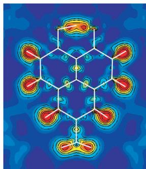
MeHPLN という物質の構造。左は中性子線回折実験から得られた原子核密度分布、右は X 線回折実験から得られた結合電子や水素結合中の水素の電子分布。水素結合中に大きな電子分極があるのが直接見えている。
