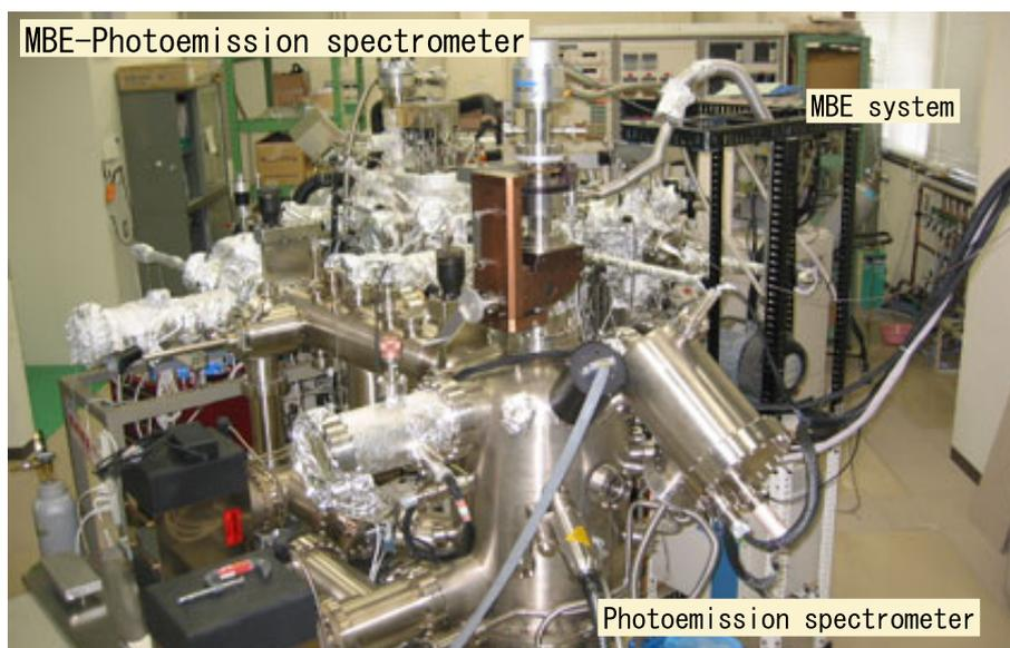
分子線結晶作成・光電子分光装置
