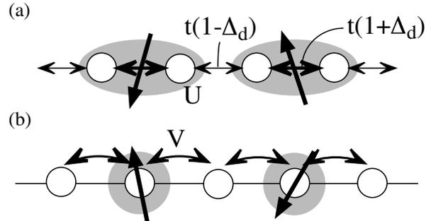
1/4 充ったバンドに対して期待される 2 つの特徴的基底状態：(a) 結合交替が強いときに出現するモット絶縁体 (b) 結合交替が弱く、格子間クーロン相互作用が重要なとき出現する電荷秩序状態 (ウィグナー結晶)
