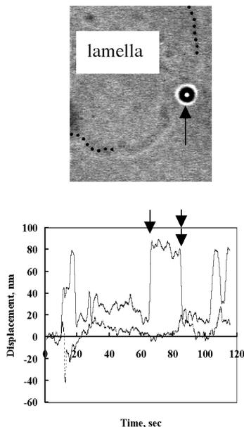
光ピンセットによる細胞膜ダイナミックスの測定。(上) 細胞にプローブのビーズ (矢印、直径1ミクロン) を光ピンセットで保持して接触させた様子。細胞膜の一部を黒点線で示す。(下) ビーズの重心位置の解析結果。膜の突出は矢印で、抗体は二重矢印で示す。
