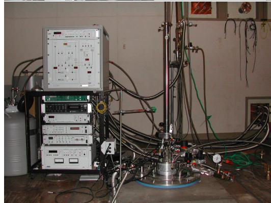
(上) 新機能物質創製用 3 ゾーンタンゲステンヒーター炉（最高温度 2300 °C 以上）。(下) 極限環境下物性測定装置（最大磁場 17T、最低温度 20mK、最大圧力 3GPa）。
