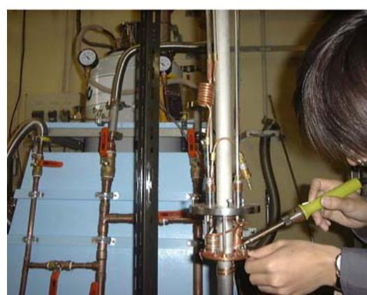
$^3He$ 冷凍機と磁化測定装置の開発
