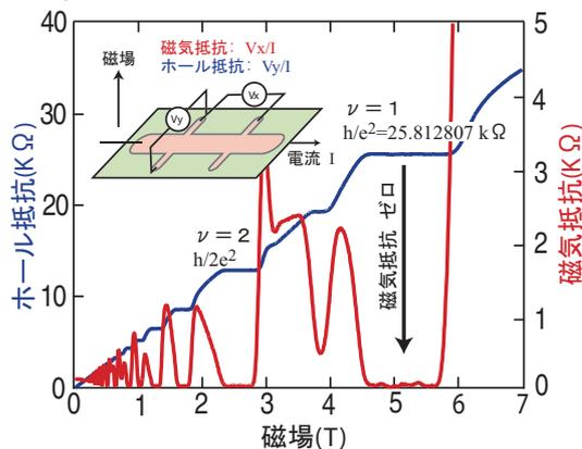
図1：量子ホール効果。挿入図の様な測定を行い、ホール抵抗と磁気抵抗の磁場依存性をプロットした。磁場  $B = nh/ve$  ( $\nu$  は整数) 付近でホール抵抗は7桁の精度で  $h/ve^2$  の量子化された値をもち、また磁気抵抗はゼロになる。
