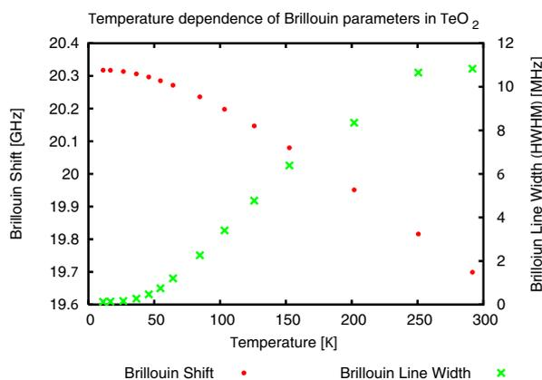
図2  $\text{TeO}_2$  結晶における誘導ブリルアン散乱の線幅 (×) とシフト (●) の温度依存性、Akhieser 損失から Landau-Rumer 損失への移行が分かる。
