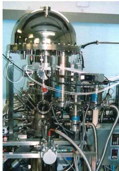
超高分解能角度分解光電子分光装置
