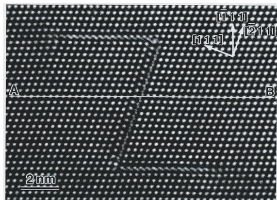
GaAs 中の Z 型転位欠陥の原子スケール像
