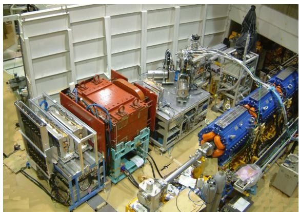
図4: 放医研 HIMAC 加速器施設において核子ノックアウト反応実験用に製作した測定器系：ビーム検出器、固体水素標的、2 アーム陽子検出器、前方磁気スペクトロメータからなる。
