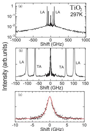
図1 室温の  $\text{TiO}_2$  結晶において観測された二成分準弾性光散乱。(a)(b)(c)の順で分光器の分解能が高くなっている。LA,TA はそれぞれ縦波、横波の音響フォノン。
