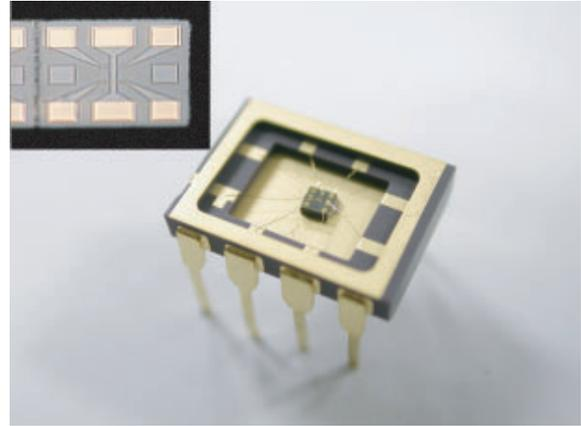
図2：量子ホール効果測定用試料写真。サンプル・ホルダーに試料をマウントし、ワイヤー・ボンダーを使用して金線で配線してある。左上挿入図はホールバーにデバイス化した試料の顕微鏡写真である。
