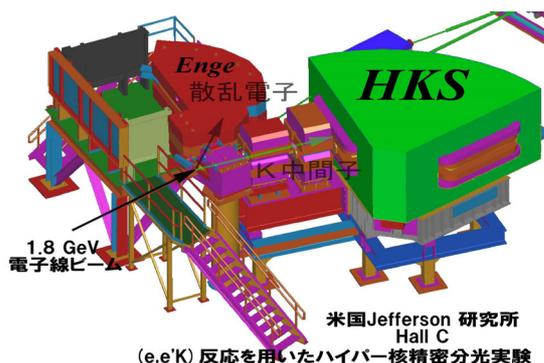
図 2: 電子線によるハイパー核分光用の高分解能 K 中間子スペクトロメータ (HKS)
