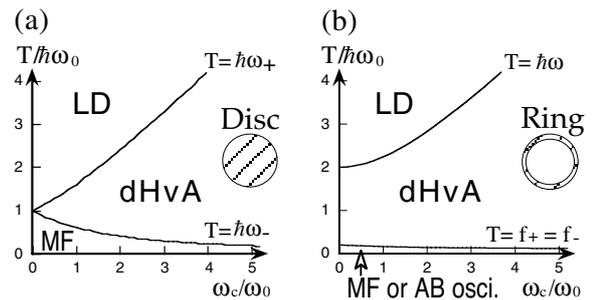
2次元メゾスコピックディスク (a) およびリング (b) の軌道磁性。縦軸、横軸は系の大きさとスケールした温度、磁場を示す。図中の LD、dHvA および MF は、それぞれランダウ反磁性、ドハース・ファンアルフェン振動およびメゾスコピック揺らぎが見られる領域を示す。アハロノフボーム (AB) 振動は非常に細いリングの場合にのみ見られる。
