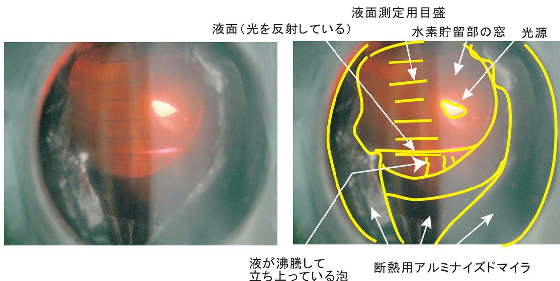
$K^0$  中間子光生成実験で使用する液体重水素標的の水素液化テストの写真。液体貯留部の樹脂フィルムの窓から液体水素が溜まっている様子が分かる。
