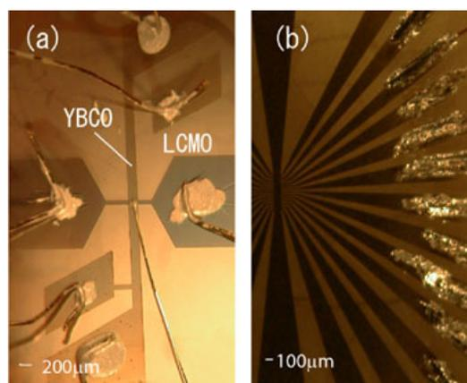
微細加工した (a) 酸化物超伝導体/強磁性体トンネル接合、(b) 高温超伝導 (YBa<sub>2</sub>Cu<sub>3</sub>O<sub>7</sub>) 薄膜
