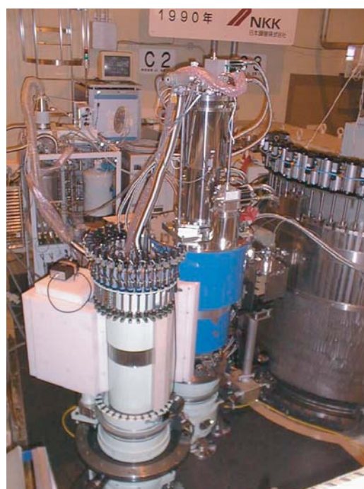
冷中性子三軸分光器 LTAS と液体ヘリウムフ リー希釈冷凍機及び 10T マグネット
