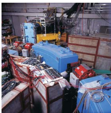
K^0 中間子光生成実験の実験装置。左の図は、光子ビームを発生するための電子加速器 (核理研 STB) とその偏向電磁石に設置された標識化光子生成装置を手前に、中性 K 中間子スペクトロメータを奥に望む写真。右の図は中性 K 中間子スペクトロメータとその上部に設置された液体重水素標的装置の冷凍機部分。
