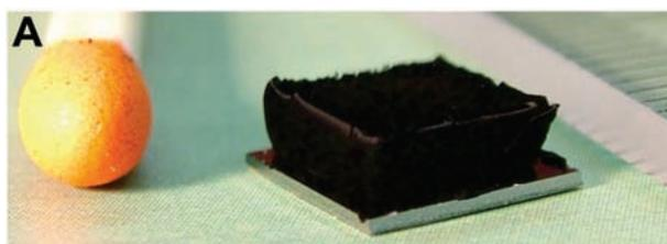
図 1.1: 肉眼でも見られる water-assisted CVD 法によって作られた高さ 2.5mm のカーボンナノチューブの束 [3]。7mm×7mm のシリコンウェハの上にカーボンナノチューブが束になって生えている。左に見えるのはマッチ棒の先端。
