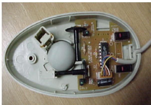
図 2.1 PS/2 マウスの構造
