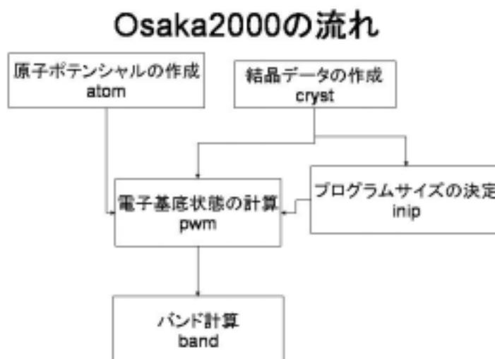
図 4.1: Osaka2000 の概略図<sup>1</sup>
