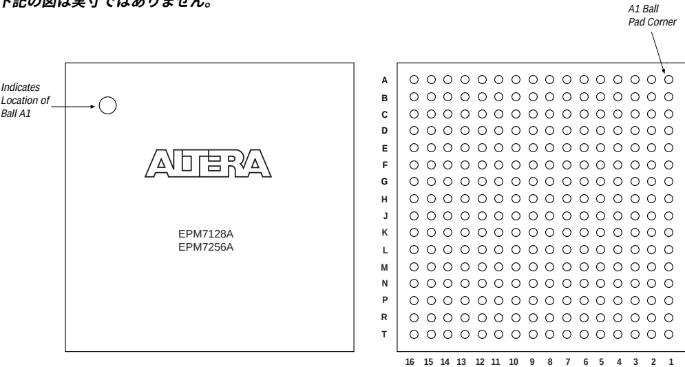
図18 256ピン、FineLine BGAパッケージのピン配置図
