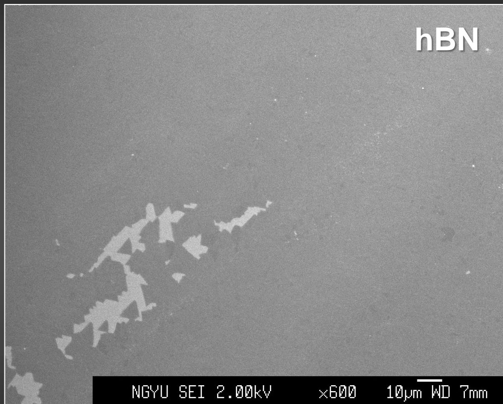
Cu箔上に成長したhBNのSEM像 250 x 150 \mu m
